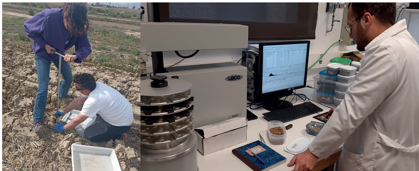
Mostreig de sòl (esquerra) per a la determinació de carboni en sòl (dreta) en un assaig de fertilització en el cultiu de l'arròs per part de l'IRTA La Ràpita. Fotos: IRTA.
