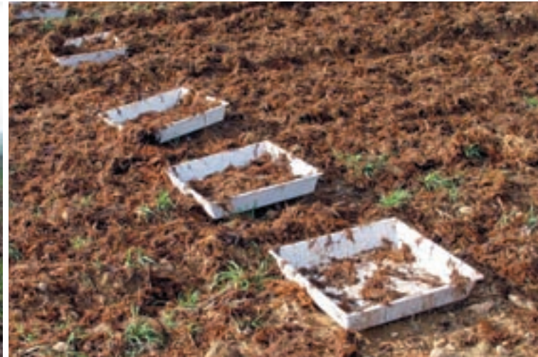
Determinació de la uniformitat de distribució transversal d'un escampador de fem mitjançant caixes, d'acord amb Norma UNE-EN 13080:2003. Foto: CMA
