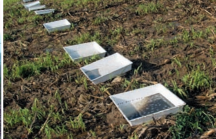
Determinació de la uniformitat de distribució transversal d'un escampador de fem mitjançant caixes, d'acord amb Norma UNE-EN 13080:2003. Foto: CMA
