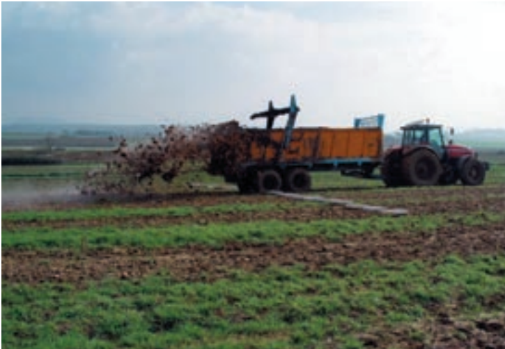
Determinació de la uniformitat de distribució transversal d'un escampador de fem mitjançant caixes, d'acord amb Norma UNE-EN 13080:2003. Foto: CMA
