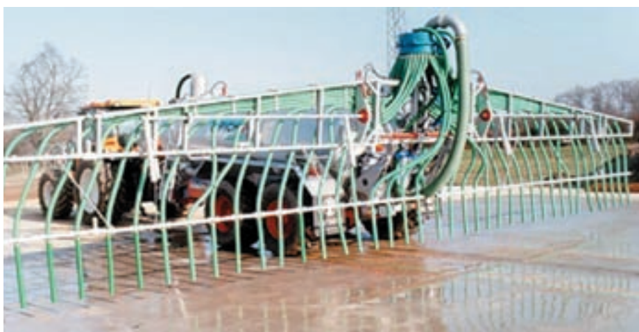
Cisterna amb sistema d'injecció localitzat en superfície: barra amb allargadors o conduccions independents. Foto: E. Gil.
