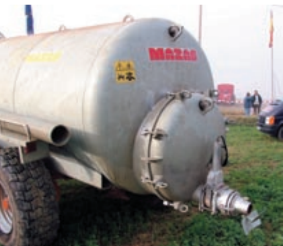
Cisterna de purí amb sistema de distribució en tota la superfície mitjançant un con-plat. Foto: CMA.
