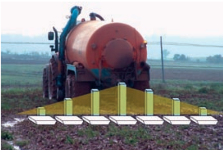
Diagrama triangular de recollida de líquid de les caixes d'una cisterna amb con i plat. Foto: CMA.
