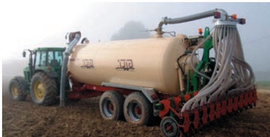
Cisterna de purí amb sistema de distribució: localització en profunditat, mitjançant enterradors o injectors. Foto: CMA.
