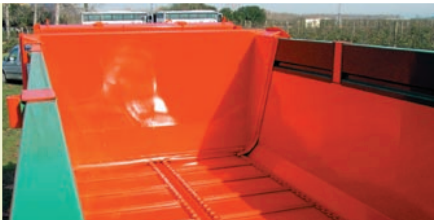
Les màquines distribuïdores de dejeccions ramaderes estan fabricades amb material resistent i protegit contra la capacitat corrosiva del fem. Foto: CMA.
