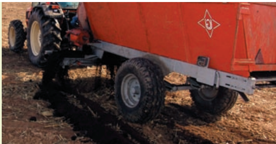
Escampador de fem amb descàrrega lateral, adient per localitzar el fem en una línia de plantació. Foto CMA.
