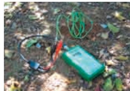
Sensor elèctric i lector instal·lat en camp per lectures no automatitzades de contingut d'humitat. Foto: J. R. Gispert
