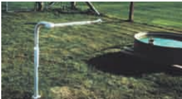
Tanc evaporimètric i radiòmetre net per estimar la demanda evaporativa de l'ambient utilitzats per a la programació de regs. Foto: J. M. Villar.
