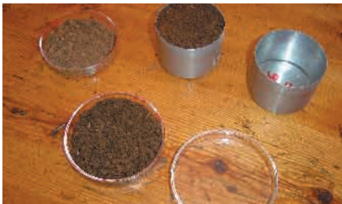
Material per a determinar el contingut volumètric d'aigua al sòl per gravimetria. Foto: J. R. Gisbert
