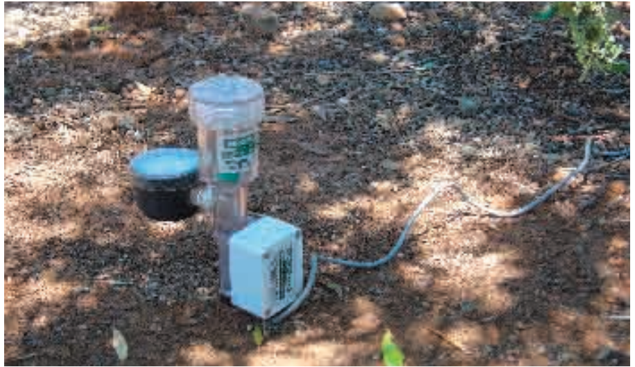
Tensiòmetre amb ransductor per avaluar demanera automatitzada el contingut d'aigua al sòl. Foto: J. R. Gisbert
