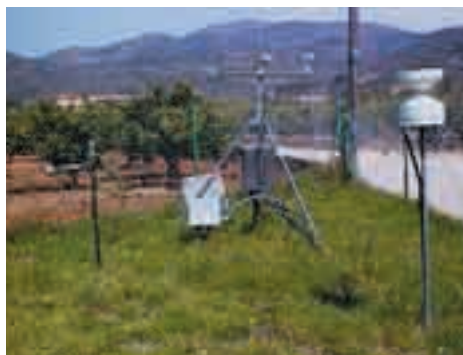
Vista general de l'estació agrometeorològica automàtica situada a Alcanar (Montsià). Totes els sensors són situats a les altures que marquen les normes, com per exemple els mesuradors de velocitat i direcció del vent que són a 2 metres del sòl.
