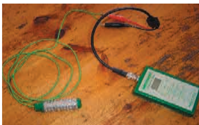
Sensor elèctric i lector per mesurar l'aigua al sòl. Foto: J. R. Gisbert
