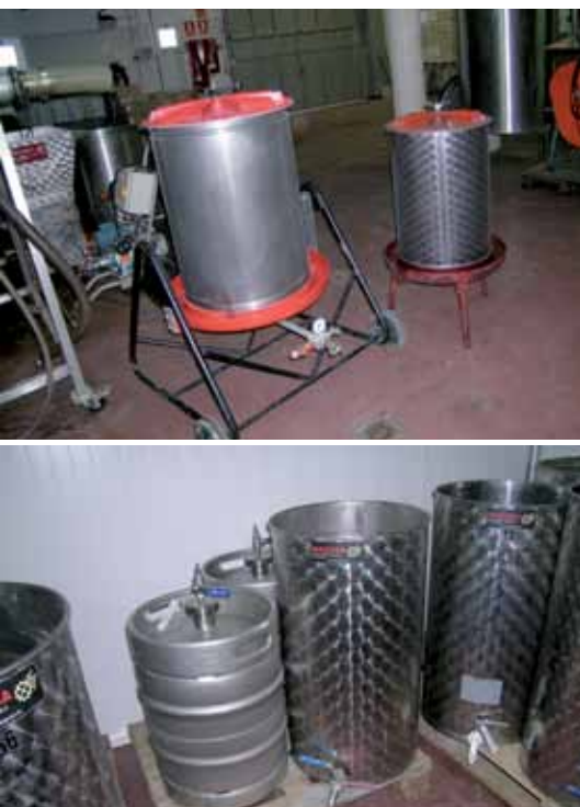
Fotos 8 i 9. Premsa i dipòsits emprats en la realització de microvinificacions en el celler de l'Incavi-EVE de Vilafranca del Penedès. Autor: M. Vilavella.
