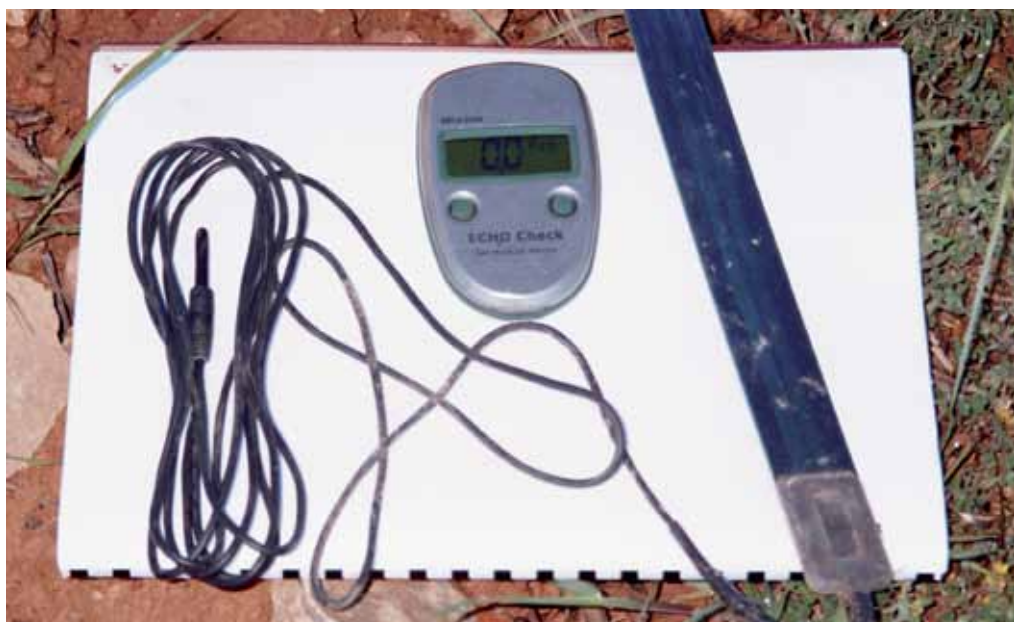
Foto 15. Sensor per controlar la humitat del sòl. Autor: A. Villarroya.
