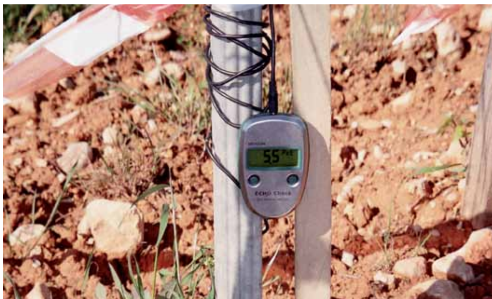
Foto 14. Col·locació i protecció de la sonda al camp. Autor: A. Villarroya.
