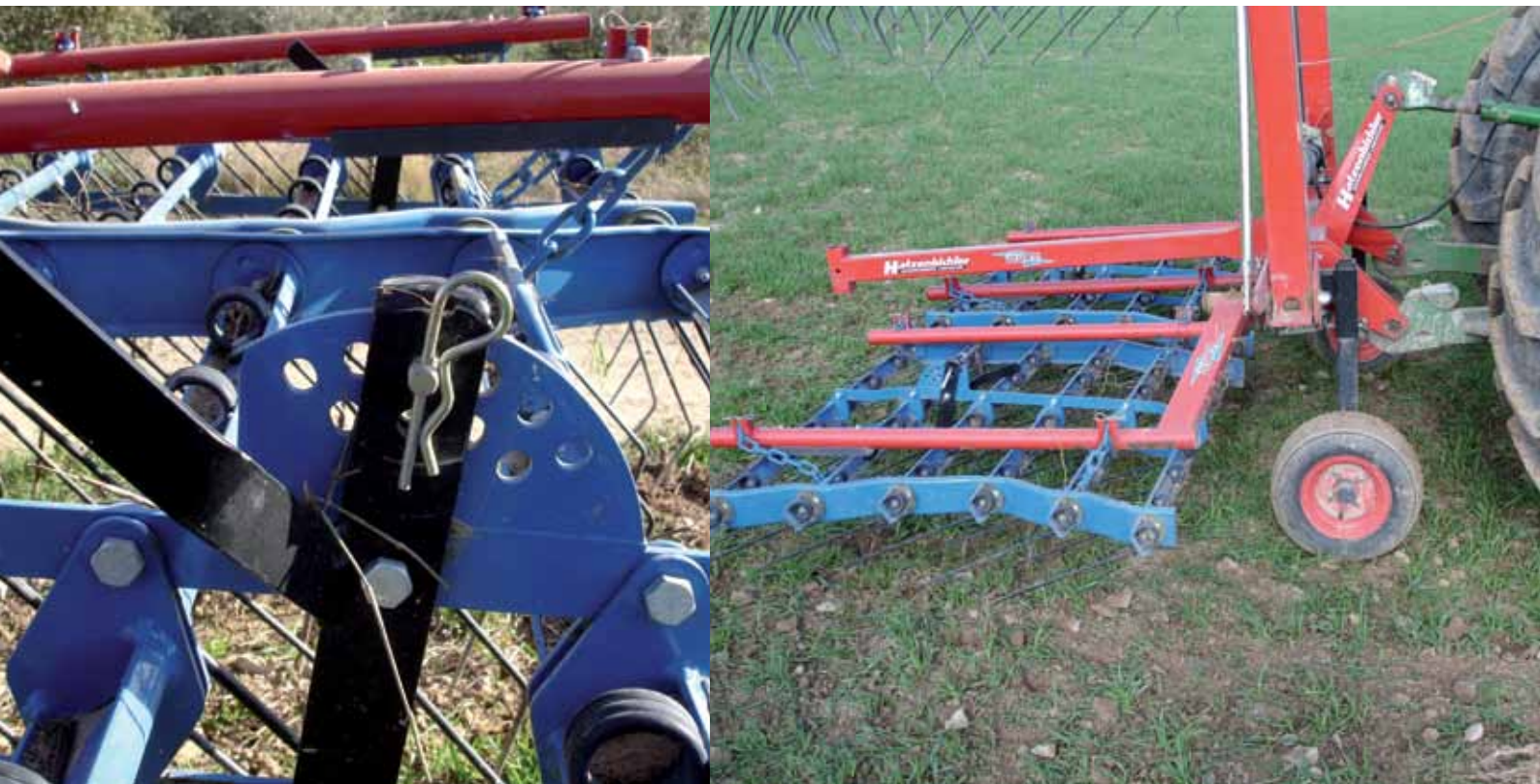
Foto 3 i 4. Detall dels elements de regulació de la grada de pues com són l'angle d'incidència de les varetes flexibles o la pressió sobre el sòl per mitjà de les rodes. Autor: J.M. Llenes. Unitat de Bones Pràctiques Fitosanitàries i Cobertura Vegetal.
