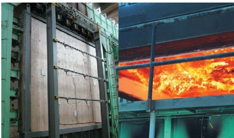
Figura 4. Ensayos de paneles de CLT, madera contralaminada. Fotografía: FP Innovations Canada.
