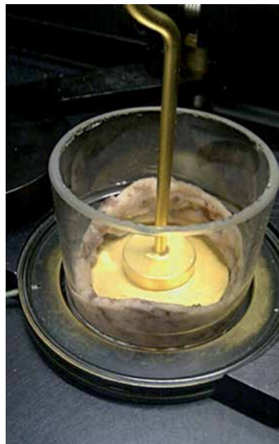
Figura 9. Registre d'una mostra de puré de calçot en un Espectrofotòmetre d'infraroig proper. Aquesta tècnica, un cop posada a punt, permet la caracterització de la mostra de manera ràpida i econòmica. Autor: Marçal Planas.
