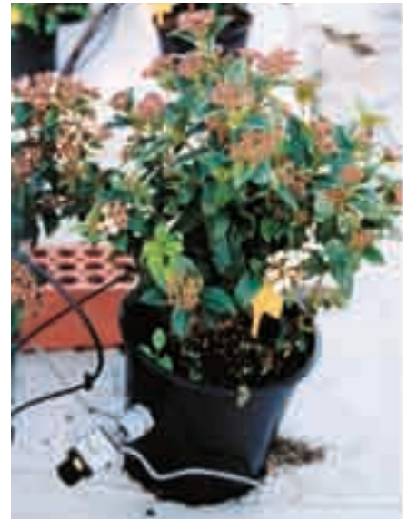
Figura 4a. Col·locació d'un electrotensiòmetre en el contenidor.
