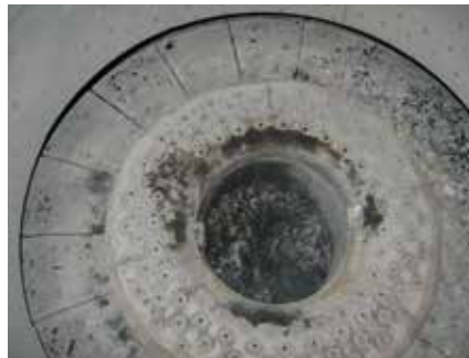
Foto 2 i 3. Vista superior de dos cremadors d'aflorament, el de la dreta amb problemes de fusió de cendres. Autor: AFIB-CTFC.
