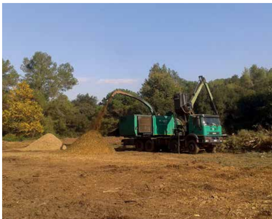
Foto 2. Treballs de trituració d'arbres sencers per obtenir estella amb destinació a una planta de cogeneració. Autora: Francesca Farnadas.
