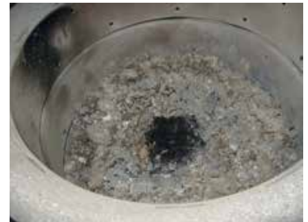
Foto 2 i 3. Vista superior de dos cremadors d'aflorament, el de la dreta amb problemes de fusió de cendres. Autor: AFIB-CTFC.
