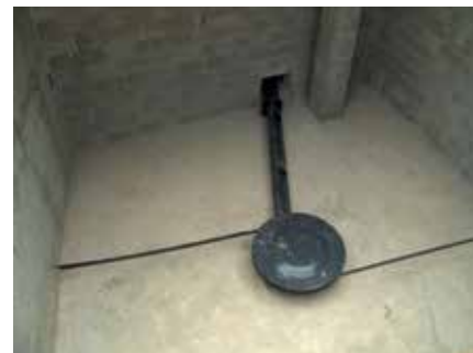
Foto 6. Plat giratori amb braços i vis sans fi. Autor: AFIB-CTFC.
