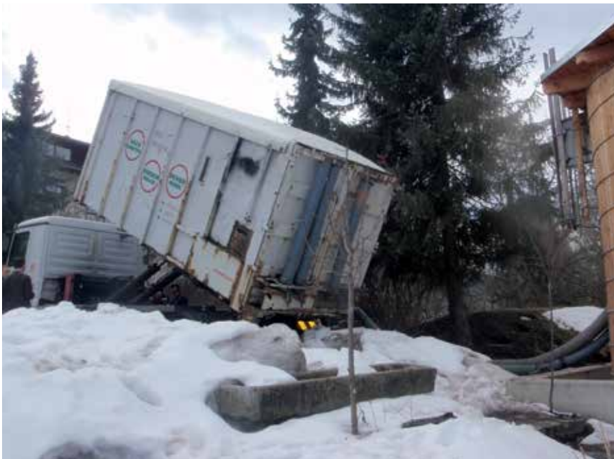
Foto 10. Descàrrega pneumàtica d'estella. Autor: AFIB-CTFC
