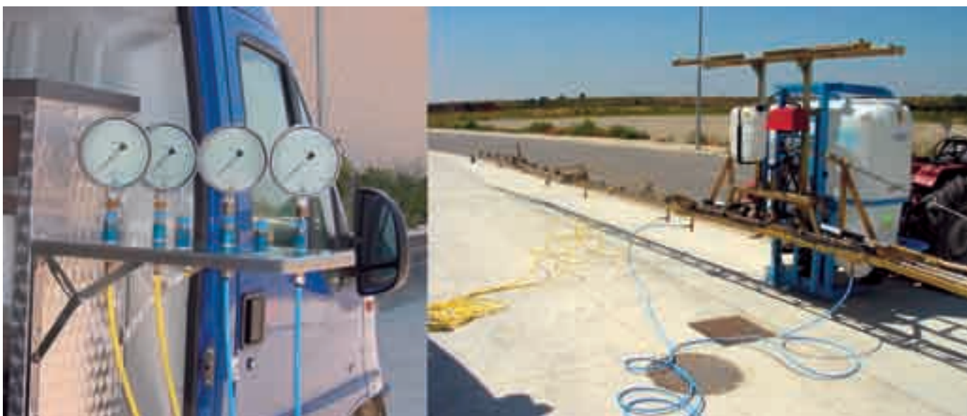
Lectura de la pressió en diferents punts de la barra en un procés d'inspecció. Foto: A. Bustos
