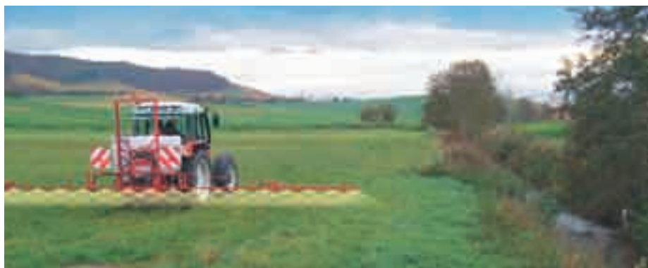
Polvoritzador hidràulic realitzant un tractament fitosanitari prop d'un curs d'aigua. És important deixar una banda de seguretat sense tractar per evitar la contaminació de l'aigua. Foto: BBA.
