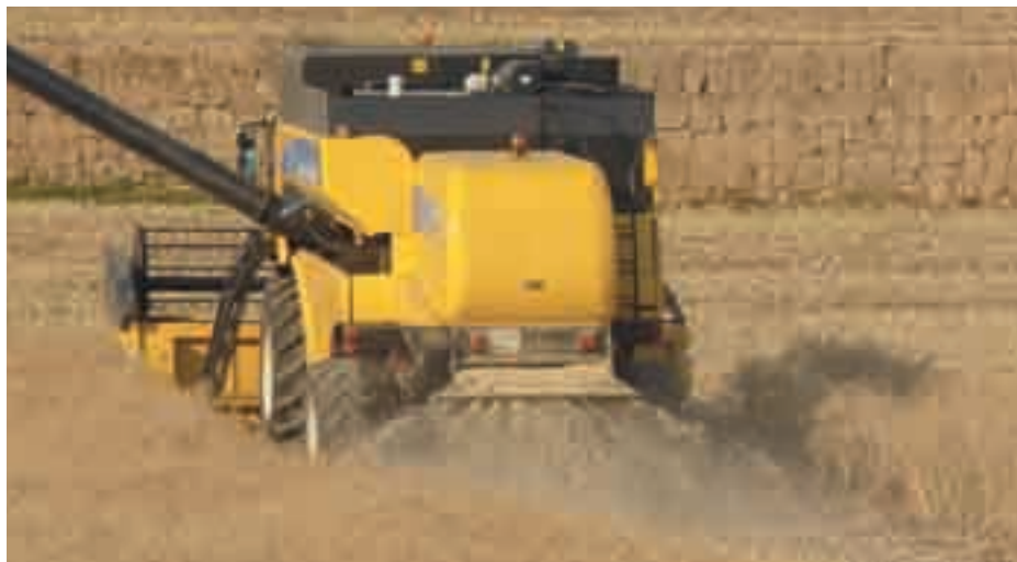
Collita. Distribució i trinxat de la palla. Operacions que cal realitzar en els sistemes de sembra directa o conreu mínim. Foto: C. Cantero
