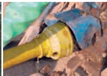
La presa de força ha d'estar ben protegida per evitar accidents. Foto: A.Bustos.
