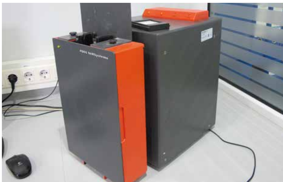
Figura 1. Equip NIR instal·lat en el laboratori d'una fàbrica de pinsos. Font: QualimaC.
