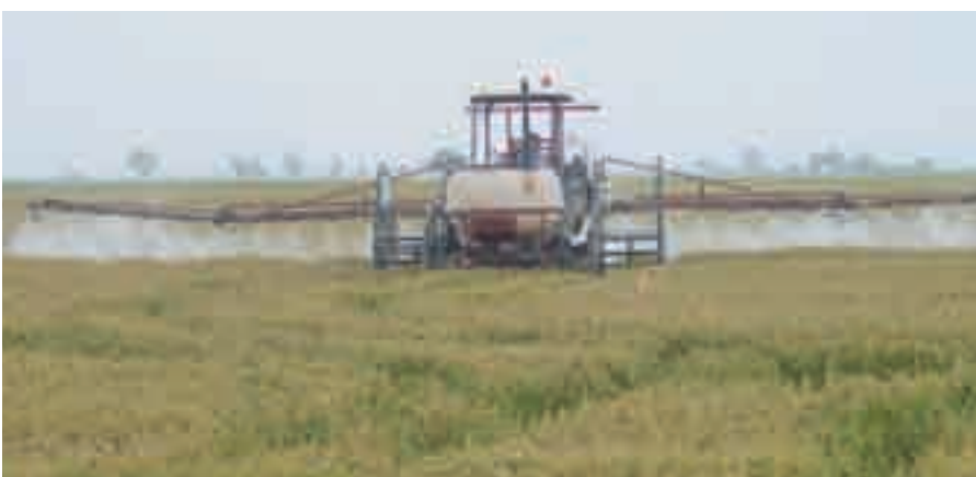
Foto 4. Tractament amb equip de tractament terrestre amb broquets de vano. Foto: G. Galimany.
