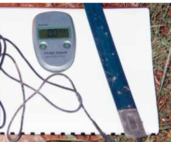
Foto 7. Sonda dieléctrica. Autor: Agustí Villarroya.
