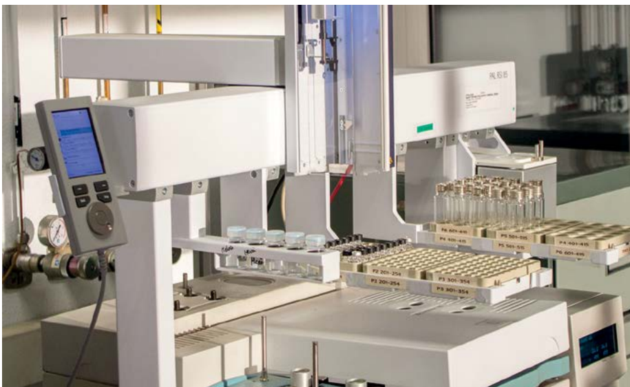
Cromatógrafo de gases con detector de espectrometría de masas con simple cuadrupolo. Foto: LAC
