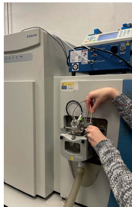
LC-HRMS: Fuente de ionización química a presión atmosférica (APCI) y espectrómetro de masas híbrido cuadrupolo-Orbitrap. Foto: ChromS-EnviFood.
