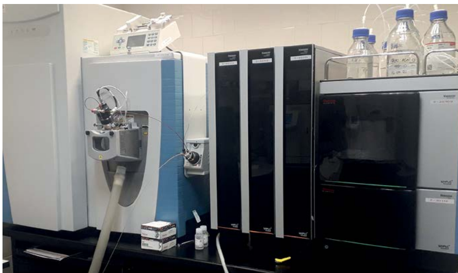
Cromatógrafo de líquidos acoplado a espectrometría de masas de alta resolución (UHPLC-HRMS). Foto: Agencia de Salud Pública de Barcelona
