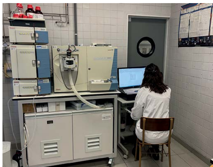
Fuente de ionización por electrospray y espectrómetro de masas de trampa de iones. Foto: ChroMS-EnviFood.
