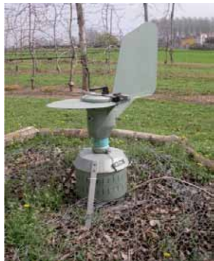
Foto 6. Mostrejador aspiratiu de l'aire (Burkard) per la captura d'ascòspores de motejat Venturia inaequalis . Autor: P. Vilardell.
