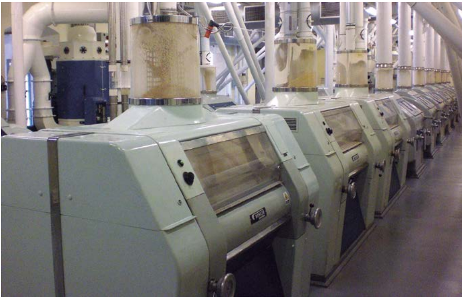
Procés industrial per a l'obtenció de sèmola i segó a partir de gra de blat dur. Foto: IRTA.
