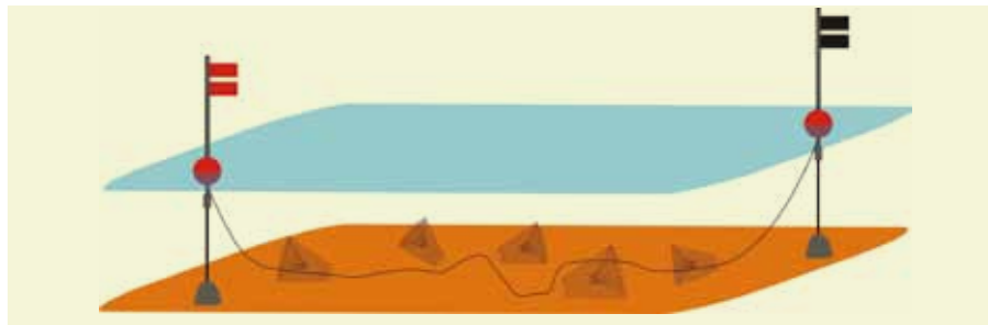
Figura 10. Esquema del calament d'una línia de nanses. Autor: Jordi Rodon
