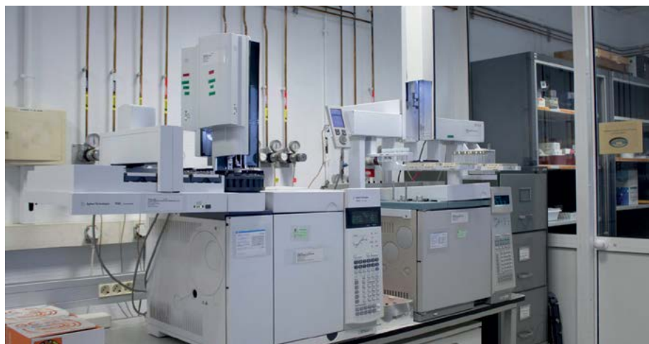
FID gas chromatography at the AFL. Photo: AFL.
