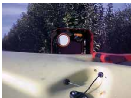
Foto 3. Sensor d'ultrasons. Autor: Centre de Mecanització Agrària.
