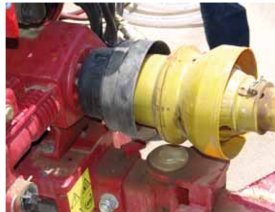
Foto 8. Protecció de la transmissió de la presa de força. Autor: Centre de Mecanització Agrària.
