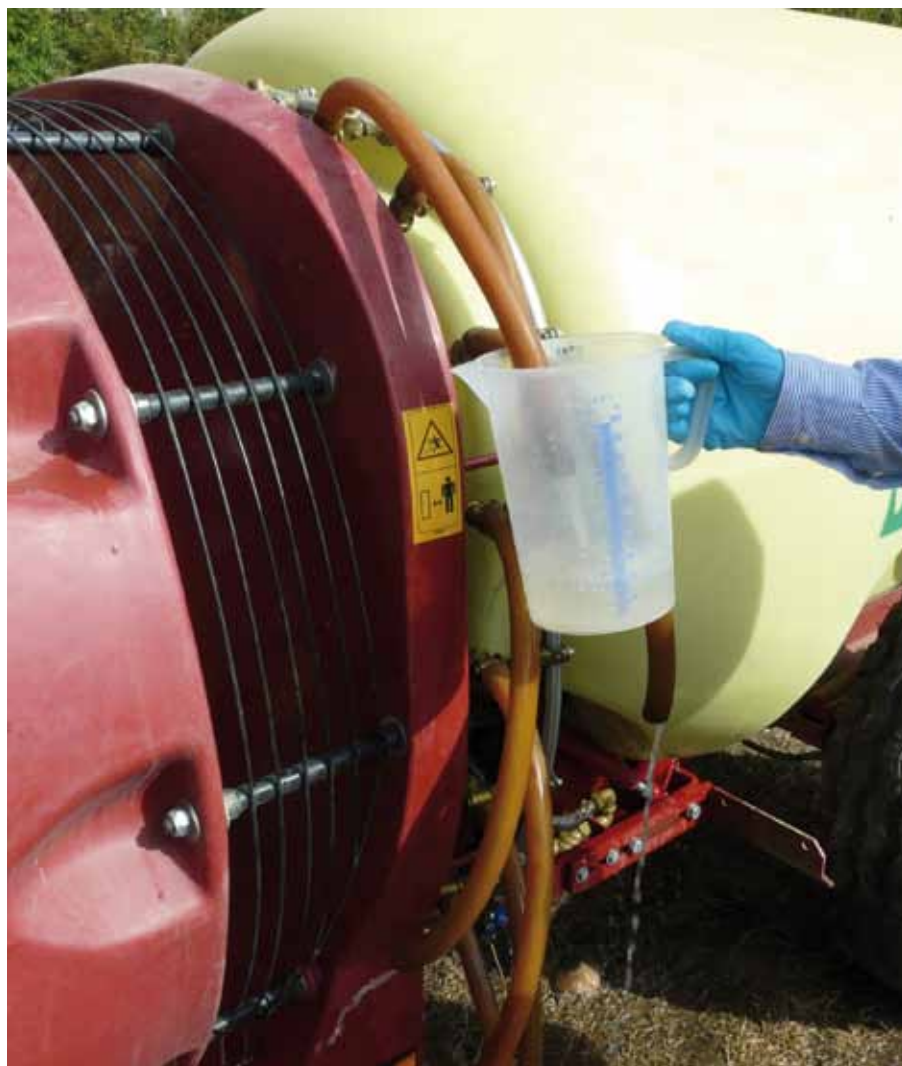
Foto 5. Mesura del cabal del broquets. Autor: Centre de Mecanització Agrària.
