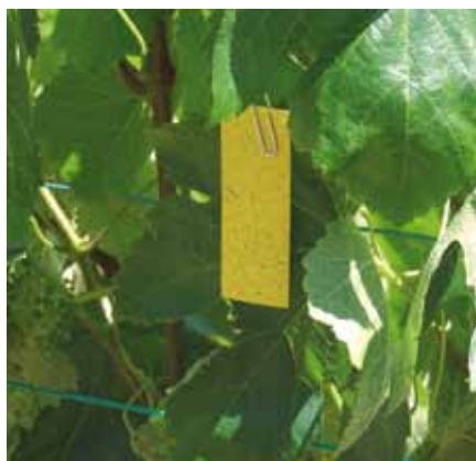
Foto 7. Col·locació de paper hidrosensible a la vegetació per a comprovar la distribució de la polvorització. Autor: Centre de Mecanització Agrària.
