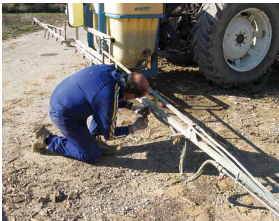
Foto 4. Operació d'intercanvi de broquets durant el procés de regulació de la barra de polvorització. Autor: Ferran Camp.
