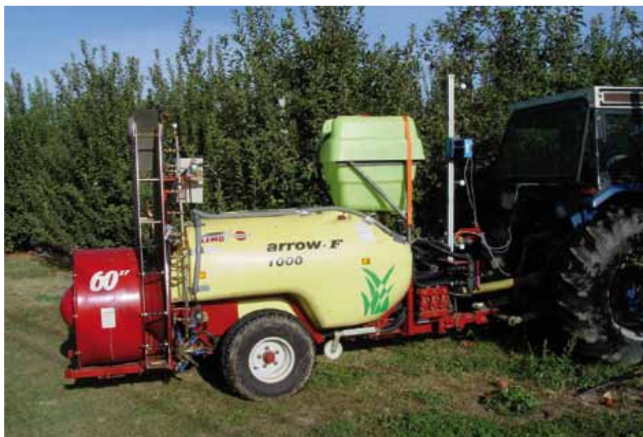
Foto 1. Prototipus del CMA-UdL per a l'aplicació proporcional als fruiters. Autor: Àlex Escolà.
