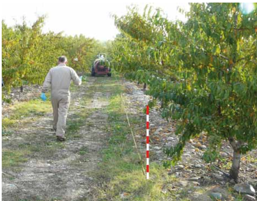
Foto 2. Comprovació de la velocitat d'avanç. Autora: Alba Fillat
