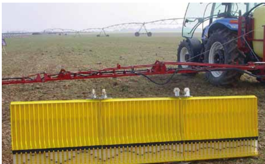
Foto 6. Manca d'uniformitat de distribució a causa de l'alçada inadequada de la barra. Autor: Àngel Bustos..
