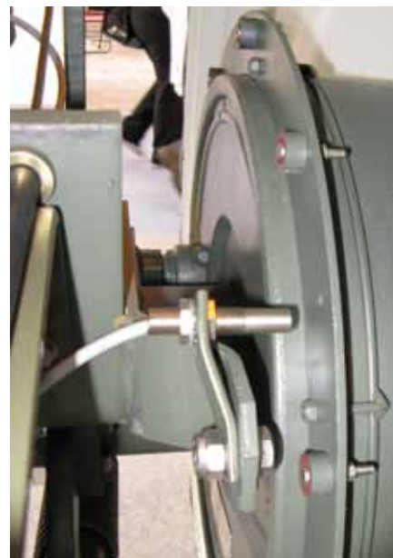
Foto 2. Sensor inductiu per a la mesura de la velocitat de treball. Autor: Ferran Camp.
