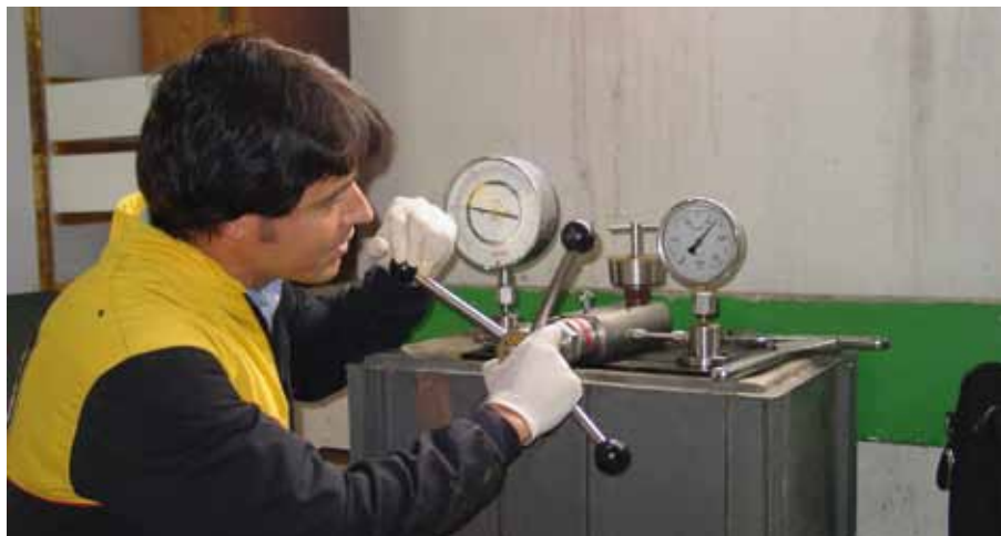
Foto 3. Inspecció. Banc de contrastació de manòmetres. Autor: Ferran Camp.
