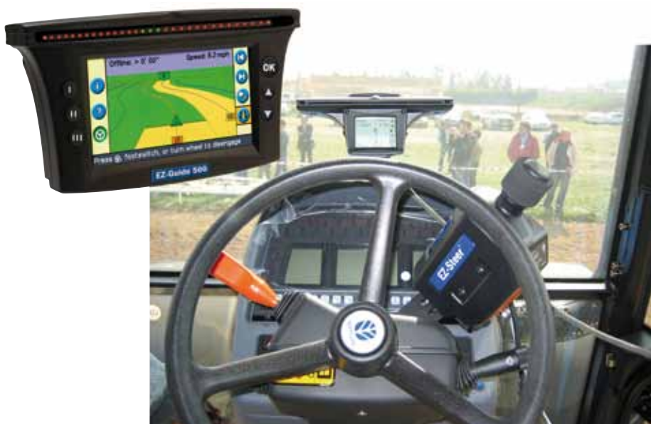
Foto 8. Sistema GPS d'ajut a la conducció. Autor: Centre de Mecanització Agrària.
