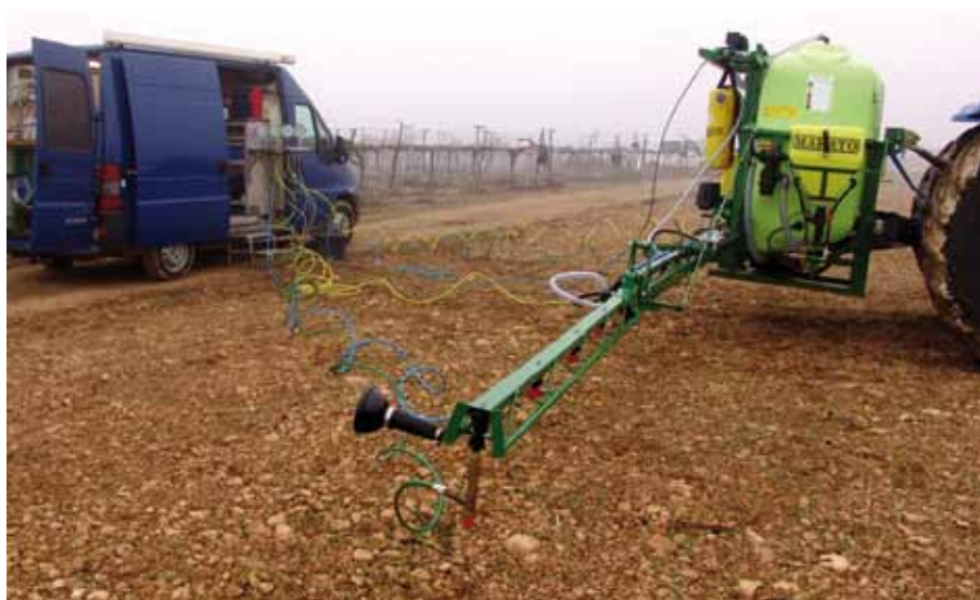
Foto 3. Inspecció. Banc de contrastació de manòmetres. Autor: Ferran Camp.
