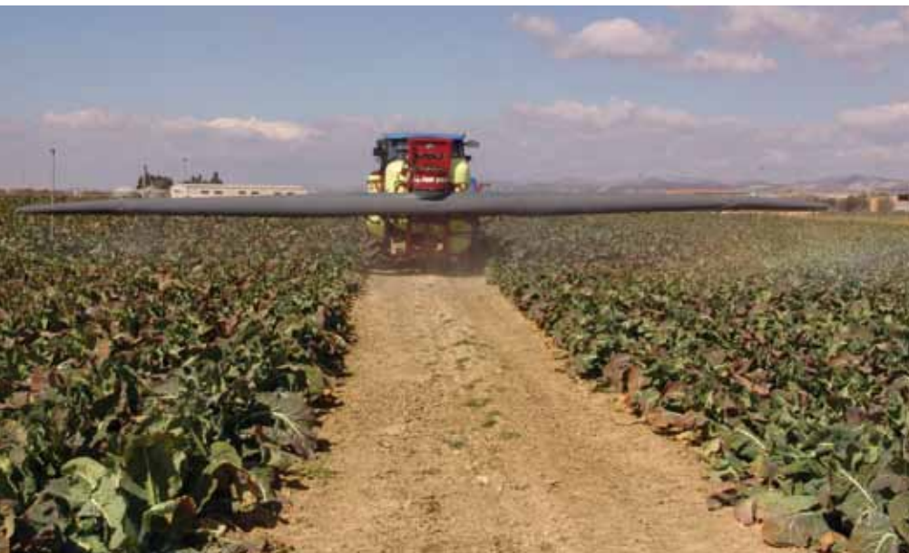
Foto 5. Polvoritzador per a conreus baixos amb assistència d'aire. Autora: Alba Fillat.
