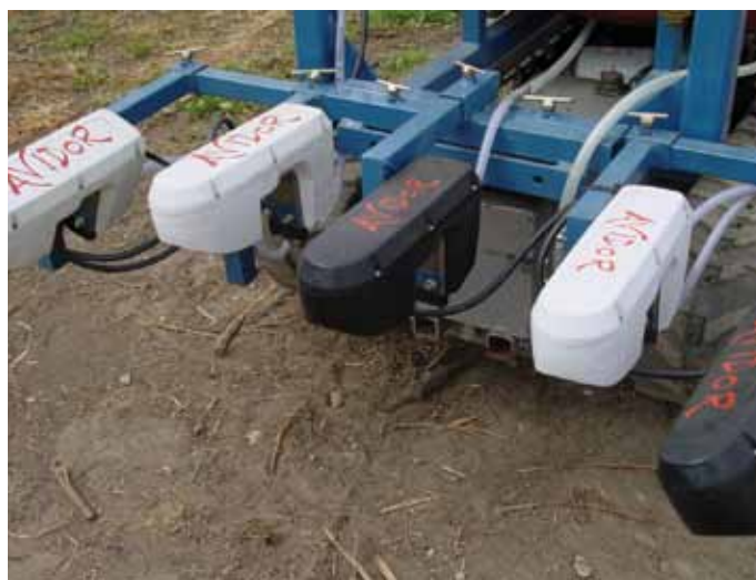
Foto 7. Polvoritzador per a l'aplicació d'herbicides amb un sistema de detecció de les males herbes. Autor: Centre de Mecanització Agrària.
