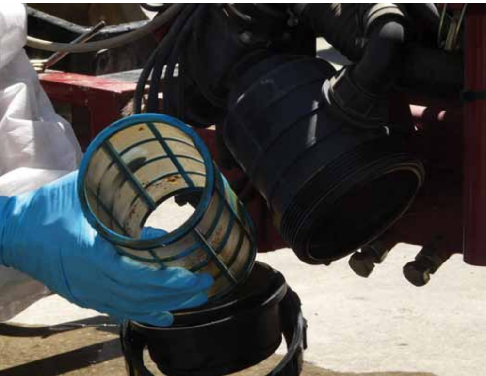
Foto 2. Operacions de manteniment en un equip d'aplicació de fitosanitaris. Autor: Felip Gràcia.
