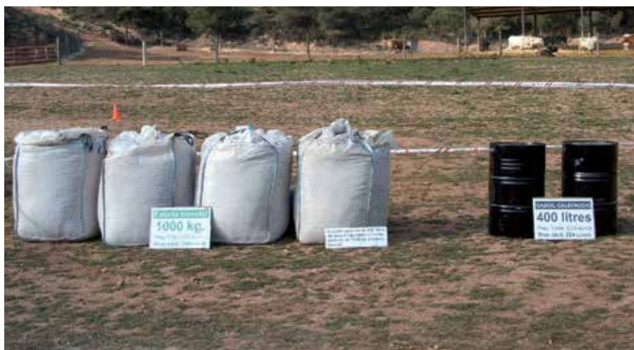
Foto 6. Comparativa de la densitat energètica de l'estella i el gasoil. Autor: David Pérez (Federació d'ADF del Bages)
