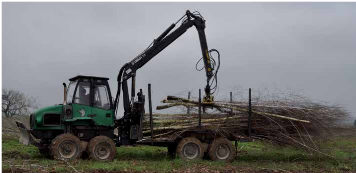
Foto 4. Autocarregador. Transport de la fusta dins la foresta. Autor: Direcció General del Medi Natural i Biodiversitat.
