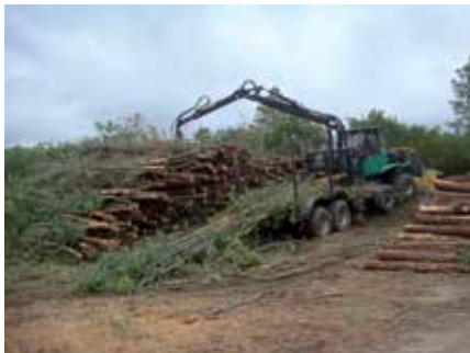
Foto 15. Extracció amb autocarregador. Autor: AFIB-CTFC.
