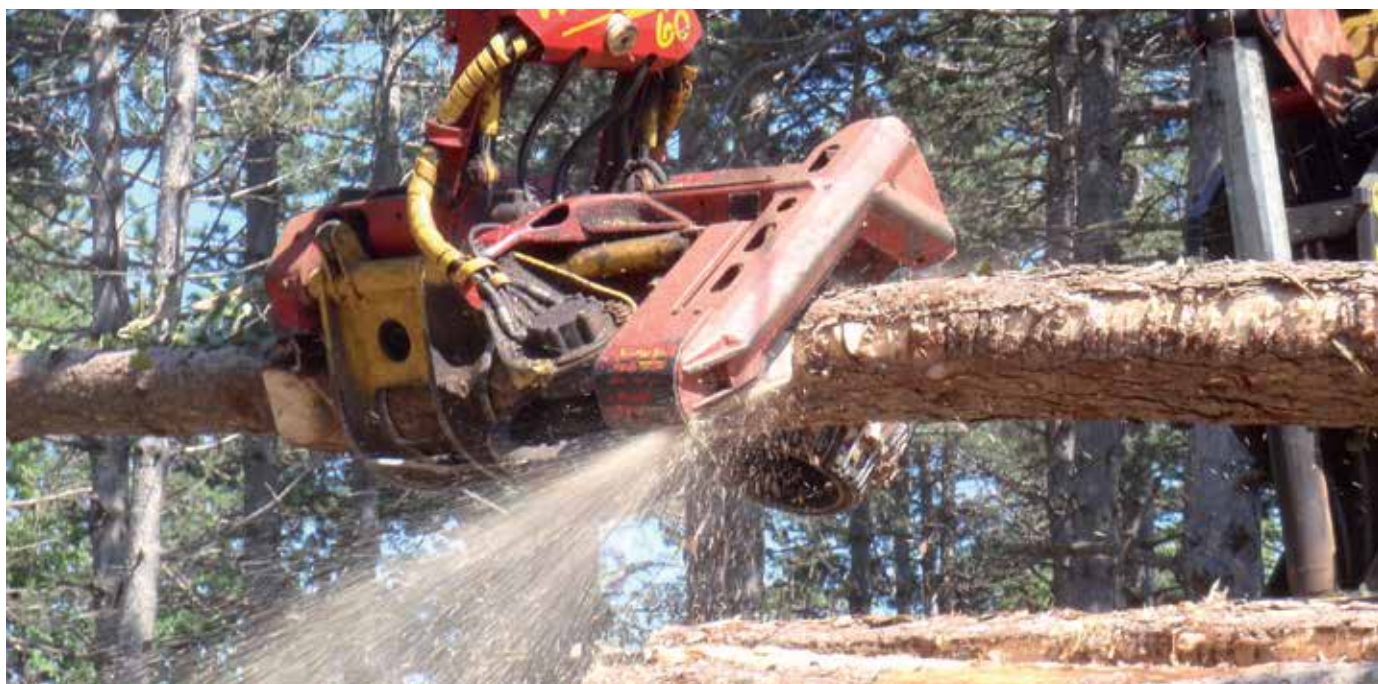
Foto 1. Capçal de processadora forestal. Procediment final de trossejat de la fusta. Autor: Direcció General del Medi Natural i Biodiversitat.
