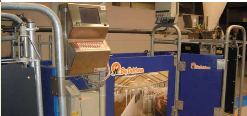
A l'esquerra: Enreixat de plàstic per a garrins. A baix: Sistema d'alimentació amb identificació electrònica. Fotos: ECA Vallfogona de Balaguer.
