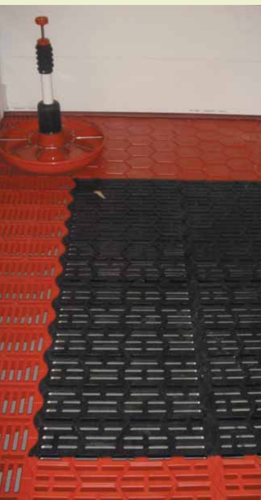
A l'esquerra: Enreixat de plàstic per a garrins. A baix: Sistema d'alimentació amb identificació electrònica. Fotos: ECA Vallfogona de Balaguer.
