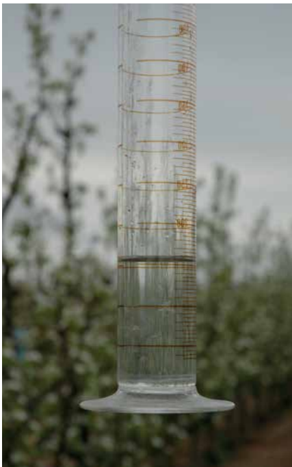
Foto 1. Proves d'uniformitat del sistema de reg (esquerra) i producció de nectarines (dreta). Foto: IRTA Programa Ús Eficient de l'Aigua.
