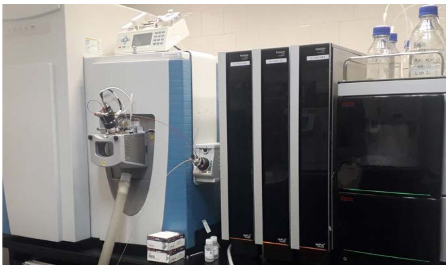
Cromatògraf de líquids acoblat a espectrometria de masses d'alta resolució (UHPLC-HRMS). Foto: Agència de Salut Pública de Barcelona
