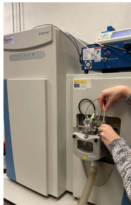
LC-HRMS: Font de ionització química a pressió atmosfèrica (APCI) i espectròmetre de masses híbrid quadrupol-Orbitrap. Foto: ChromS-EnviFood.
