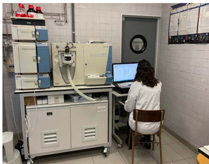
Font de ionització d'electrosprai i espectròmetre de masses de trampa de ions. Foto: ChroMS-EnviFood.
