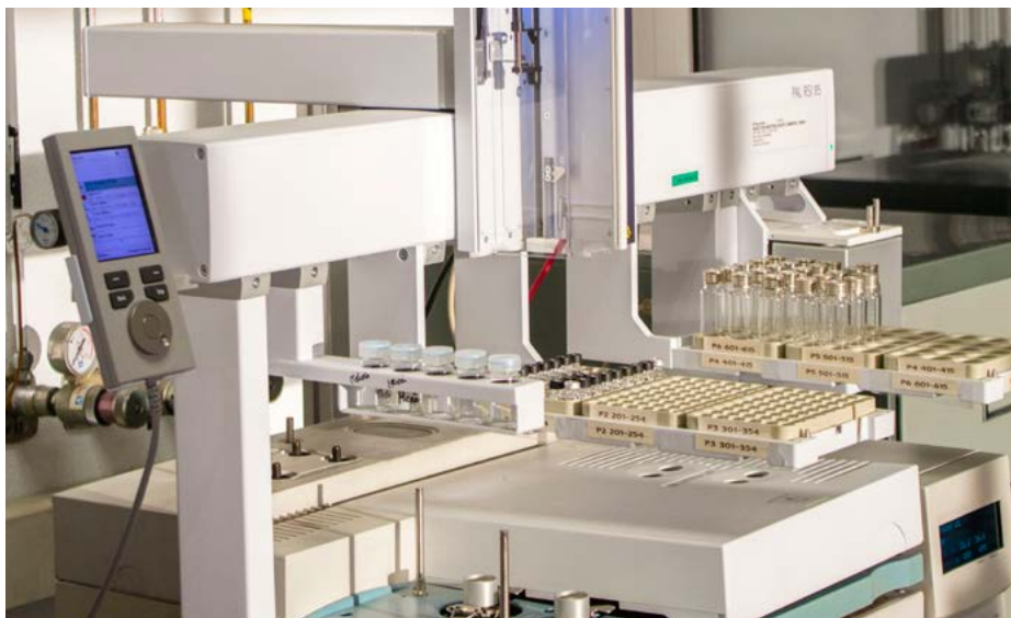
Cromatògraf de gasos amb detector d'espectrometria de masses amb simple quadrupol. Foto: LAC
