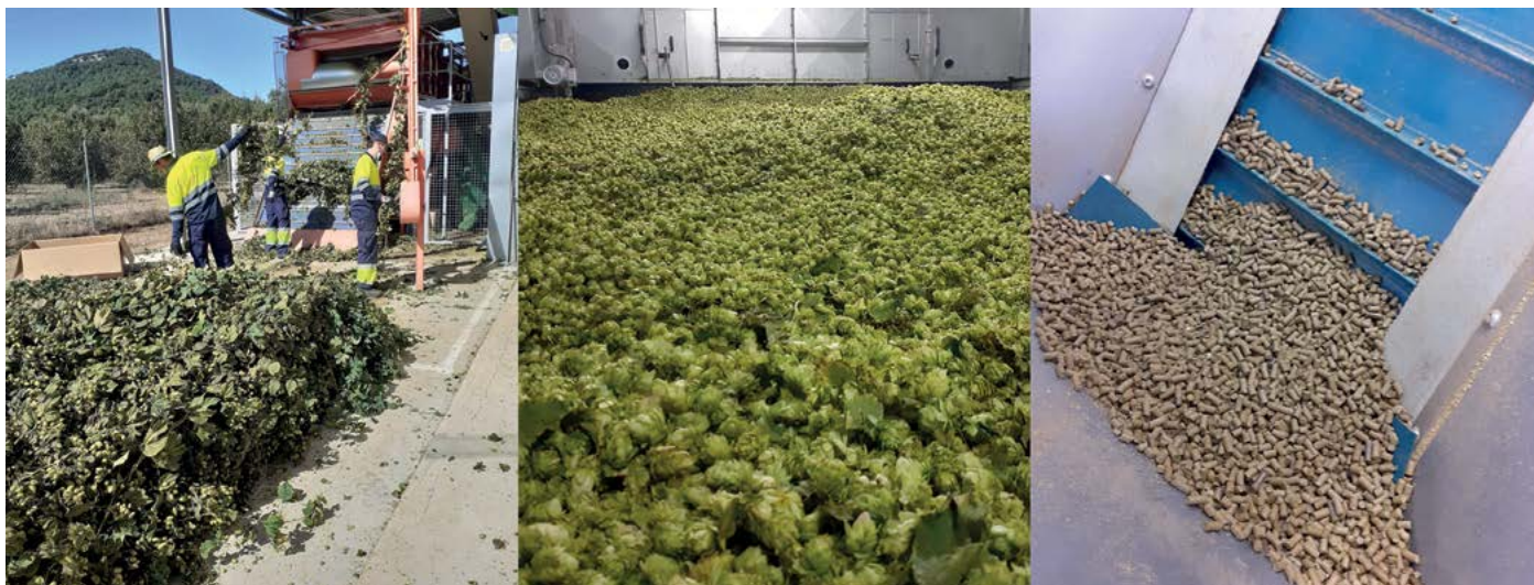
Detalls del procés de transformació del llúpul: separació dels cons de llúpul, estabilització de la temperatura dels cons en cambra d'acimatació i llúpul ja granulat. Font: Kevin Tejedera. Enginyer agrònom. SA DAMM.
