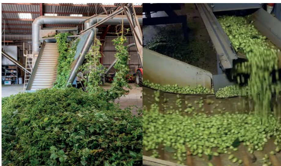
Màquina "peladora". Separació de les flors de la resta de la planta i tutors. Foto: Hop von Hallertau- D'Alsace et d'ailleurs.
