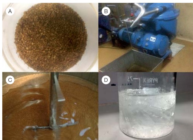
A: Celulosa cruda recuperada. B: Centrifugación para separar hueso y líquido iónico. C: Líquido iónico y hueso. D: Líquido iónico. Fotografías: Grupo Operativo.
