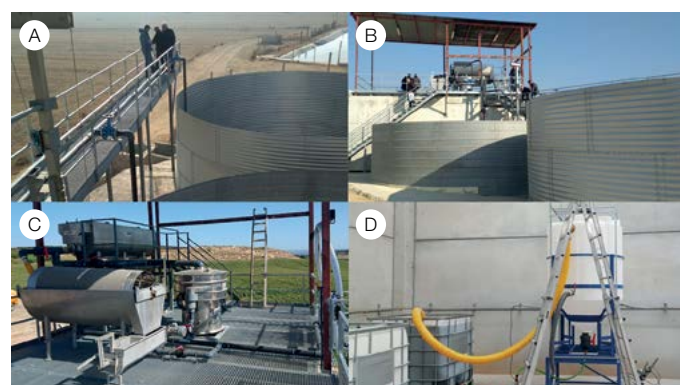
A, B y C: imágenes planta piloto SAT La Vall 100 m 3 . D: planta prepiloto tratamiento purines 1 m 3 . Fotografías: Grupo Operativo.
