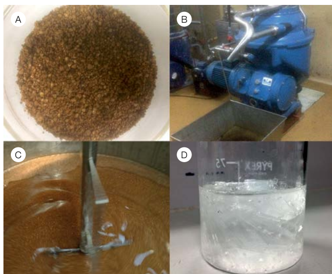
A: Celulosa crua recuperada. B: Centrifugació per separar pinyol i líquid iònic. C: Líquid iònic i pinyol. D: Líquid iònic. Fotos: Grup Operatiu.
