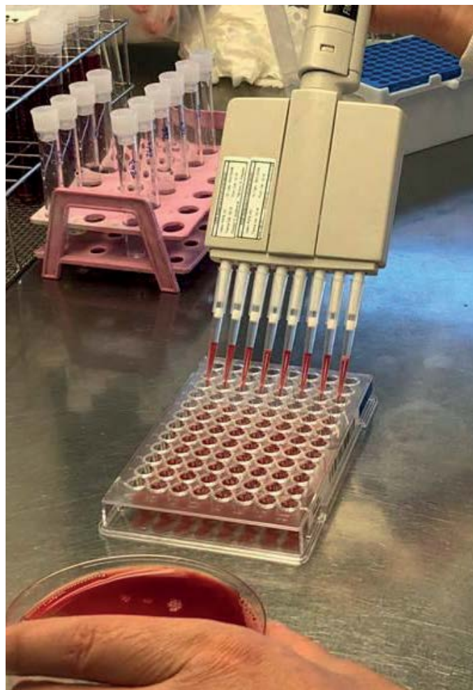
Realització al laboratori d'antibiogrames de mostres de llet de vaques amb recompte de cèl·lules somàtiques altes mitjançant la tècnica de la concentració mínima inhibidora (MIC). Foto: Lourdes Migura.
