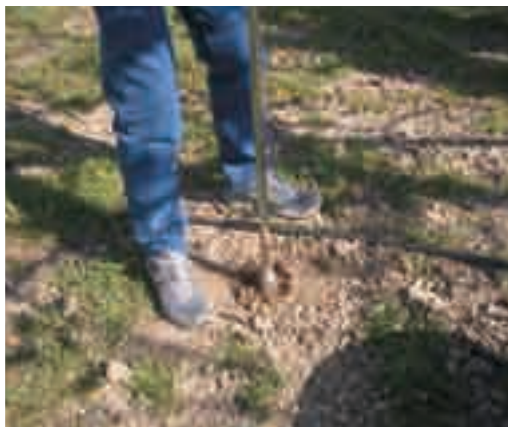
2. Presa de mostra de sòl. Foto: X. Sentís
