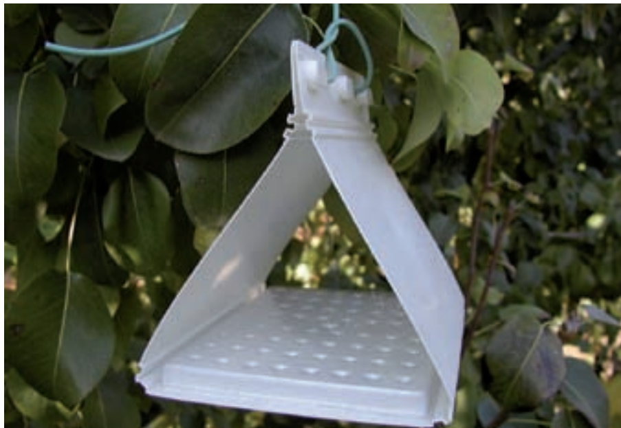
Foto 6. Unitat de control de l'autoconfusió. Foto: R. Torà
