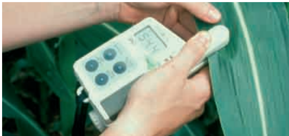
Mesura de l'estat nutricional del panís mitjançant la mesura òptica del contingut de clorofil·la de les fulles (SPAD). Foto: J. Lloveras, UdL.
