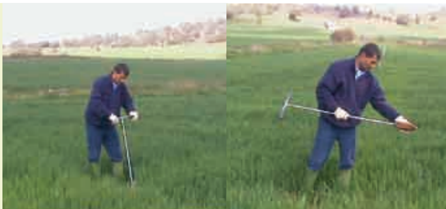
Mostreig del sòl per a la determinació del contingut de nitrogen mineral. Foto: Secció d'Avaluació de Recursos Agraris, DARP
