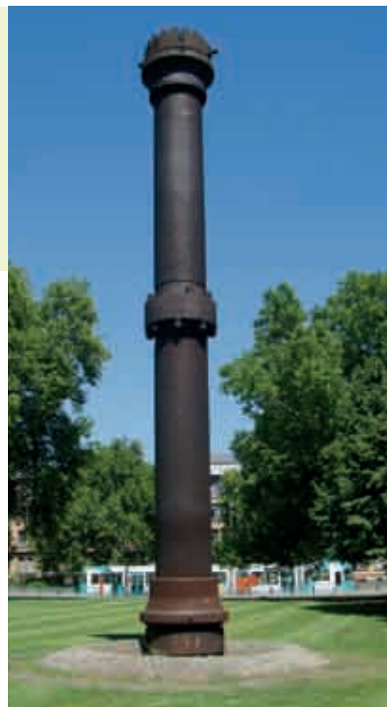
Primer reactor utilitzat per l'enginyer i químic Carl Bosch per fabricar amoníac ( \text{NH}_3 ) l'any 1913. Necessari per fabricar tots els fertilitzants nitrogenats de síntesi. (BASF Limburgerhof, Alemanya). Foto: JM. Villar.
