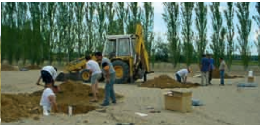
Instal·lació de lisímetre de capil·laritat passiva a la zona regable del Canal d'Urgell per estudiar el rentat de nitrats. Foto: JM. Villar.
