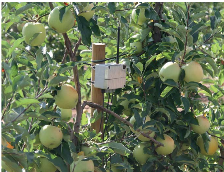
Mòdul sense fils per a la mesura de sensors a camp. Foto: IRTA.
