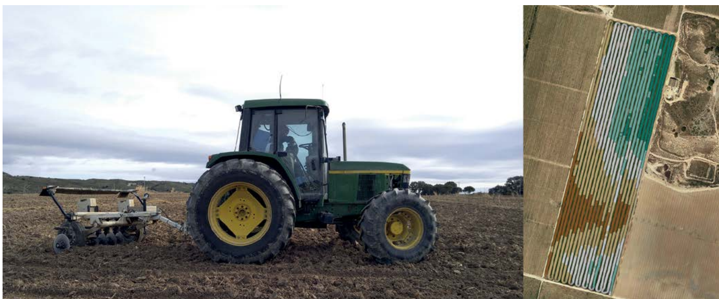
Figura 5. Sensor proper Veris 3100 que permet obtenir mesures georeferenciades de la conductivitat aparent del sòl cada segon a dues profunditats (esquerra). Els punts de mesura obtinguts (dreta) cal interpolar-los amb processos geoestadístics per tal de representar-los en forma de mapa continu. Autor: Grup de Recerca en AgròTICa i Agricultura de Precisió, GRAP.
