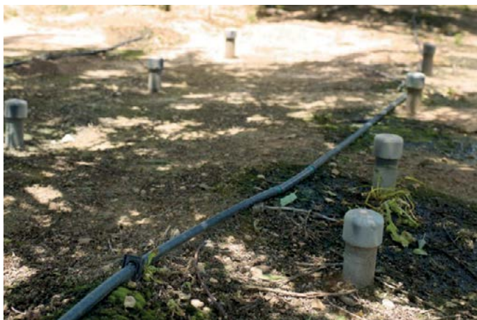
Tubs instal·lats al sòl d'una plantació d'ametller per a mesurar l'humitat a diferents profunditats. Foto: IRTA.
