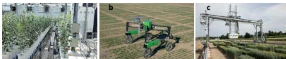
Figura 4. Exemple de plataformes de fenotipatge. Phenoarch (a), dins d'un hivernacle, Phenomobile (b) i Field Scanalyzer (c) al camp. Font: Phenoarch INRA (Montpellier, França), CSIRO (Canberra, Austràlia) i Rothamsted Research (Harpenden, UK).
