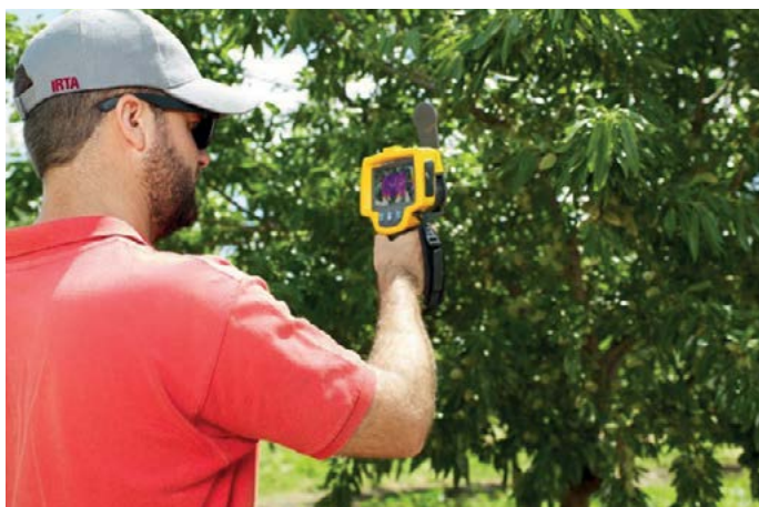
Mesura de la temperatura foliar com indicador de l'estat hídric dels cultius. Foto: IRTA.
