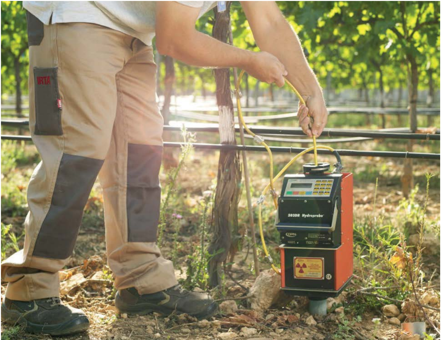
Mesures d'humitat del sòl amb sonda de neutrons. Foto: IRTA.
