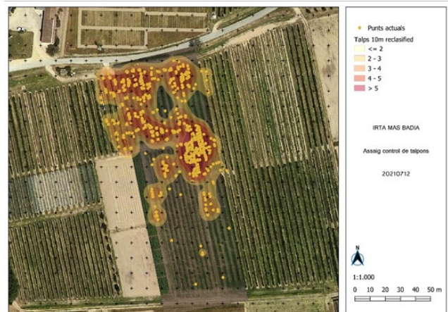
Figura 5. Ortomapa generat a partir de les fotos obtingudes amb el DRON, on s'observa la gradació de colors en funció de la densitat de forats detectat a través de l'anàlisi d'imatge.
