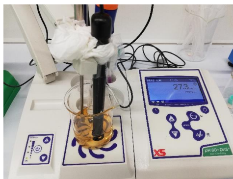
Figura 1. Elèctrode d'ió selectiu de nitrats per determinar la seva concentració en mostres de tija de blat de moro, com a part del protocol del CSNT.
