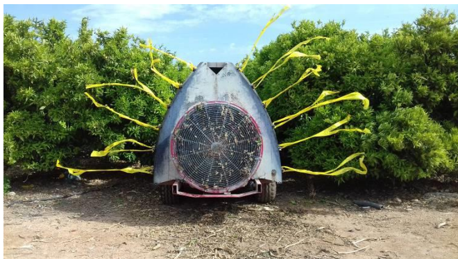
Foto 1. Calibratge d'un polvoritzador amb assistència d'aire en parcel·la de mandamines var. Clemenules (Cítrics Terres de l'Ebre SAT, 2018. Santiago Planas).
