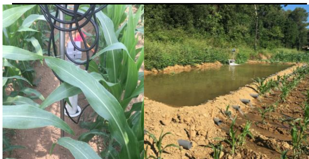
Foto 2. Sensor de nivell de la làmina d'aigua (esquerra) i vista general del basal distribuïdor de l'aigua a les regues (dreta) (Foto: Enginyeria i Gestió del Reg).
