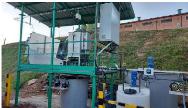
Foto 1. Vista de la planta pilot per a la precipitació de K-estruvita (Foto: Albert Magrí).
