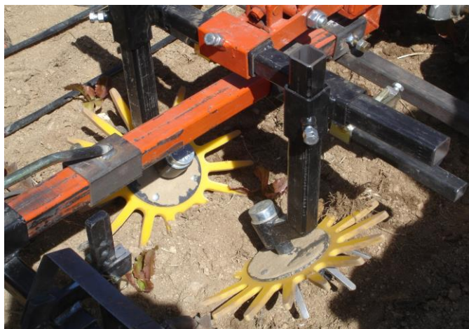
Figura 1: Detall del funcionament dels dits desherbadors en cultiu d'enciam.
