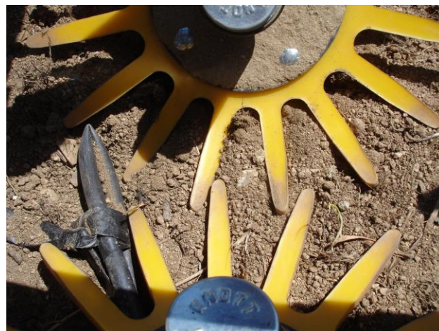
Figura 4: Detall de la regulació dels dits desherbadors en posició més agressiva (Creuant-se els dits uns 2cm)
