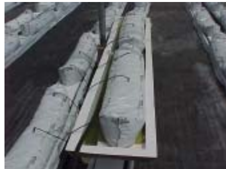
Figura 6. Detalle de un tanque lisimétrico de los habitualmente utilizados en los sistemas de riego a la demanda. En la foto de la derecha pueden observarse las electrosondas y en la de la izquierda la manta capilar.
