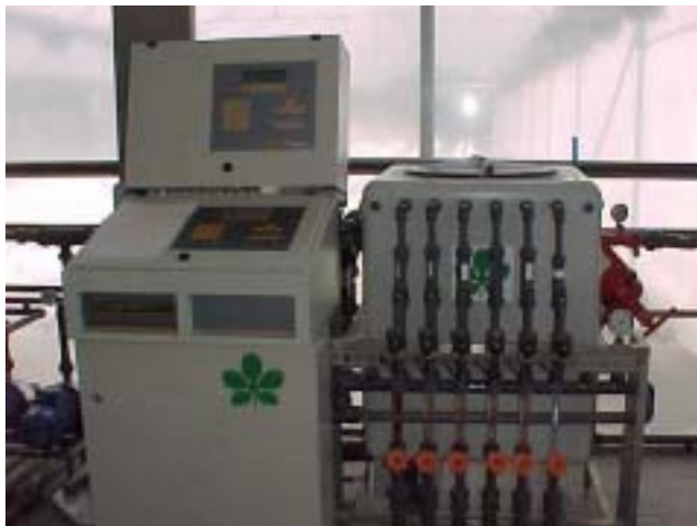
Figura 7. Controlador de riego y cabezal de un sistema de cultivo sin suelo con recirculación.
