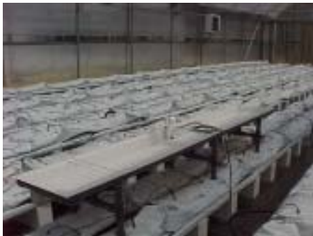
Figura 6. Detalle de un tanque lisimétrico de los habitualmente utilizados en los sistemas de riego a la demanda. En la foto de la derecha pueden observarse las electrosondas y en la de la izquierda la manta capilar.
