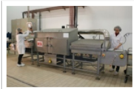
Figura 3. Equip d'alta pressió i microones instal·lats a IRTA-Monells (Foto: B. Martinez – IRTA).
