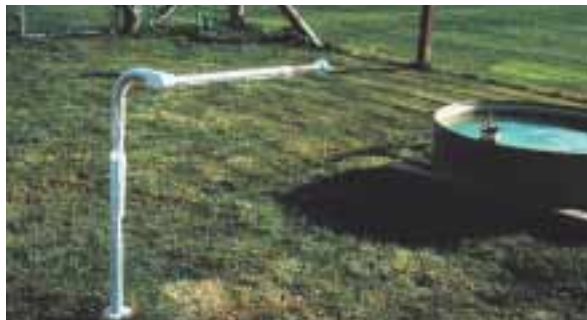
Tanque evaporimétrico y radiómetro neto para estimar la demanda evaporativa del ambiente, utilizados para la programación de riegos. Foto: J. M. Villar
