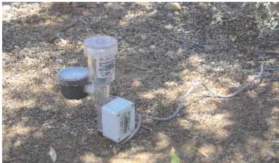
Tensiómetro con transductor para evaluar de forma automatizada el contenido de agua en el suelo. Foto: J. R. Gisbert
