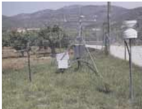
Vista general de la estación agrometeorológica automática situada en Alcanar (Montsià). Todos los sensores están situados a las alturas que marcan las normas, como por ejemplo los medidores de velocidad y dirección del viento, que están a 2 metros del suelo.
