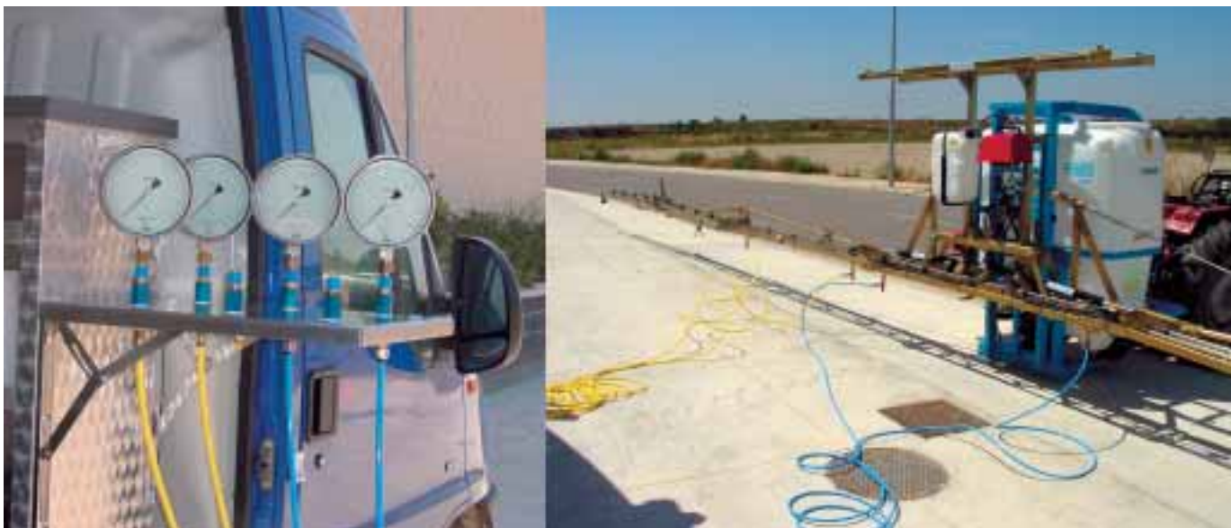
Lectura de la presión en diferentes puntos de la barra en un proceso de inspección. Foto: A. Bustos
