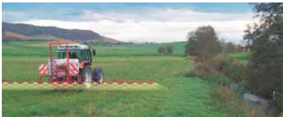
Pulverizador hidráulico realizando un tratamiento fitosanitario cerca de un curso de agua. Es importante dejar una banda de seguridad sin tratar para evitar la contaminación del agua. Foto: BBA.
