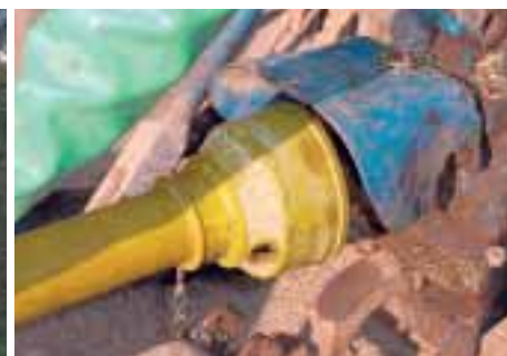
La toma de fuerza debe estar bien protegida para evitar accidentes. Foto: A.Bustos.
