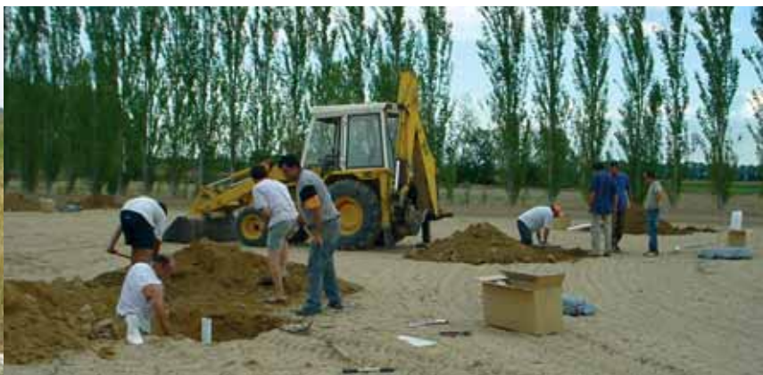
Instalación de lisímetro de capilaridad pasiva en la zona regable del Canal de Urgell para estudiar el lavado de nitratos. Foto: JM. Villar.
