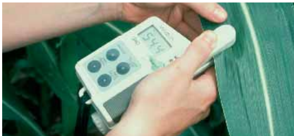
Medida del estado nutricional del maíz mediante la medida óptica del contenido de clorofila de las hojas (SPAD). Foto: J. Lloveras, UdL.
