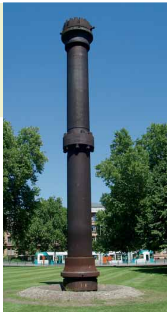
Primer reactor utilizado por el ingeniero y químico Carl Bosch para fabricar amoníaco ( \text{NH}_3 ) el año 1913. Necesario para fabricar todos los fertilizantes nitrogenados de síntesis. (BASF Limburgerhof, Alemania). Foto: JM. Villar.
