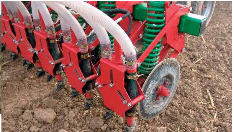
Máquina para la inyección de purines. Foto: Centro de Mecanización Agraria, DARP.
