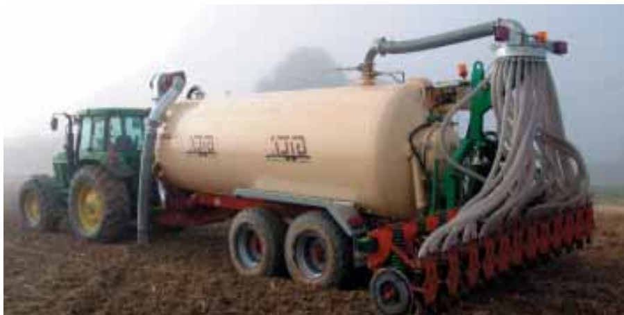
Cisterna de purín con sistema de distribución: localización en profundidad, mediante enterradores o inyectoros. Foto: CMA.
