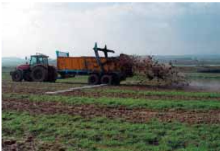
Determinación de la uniformidad de distribución transversal de un esparcidor de estiércol mediante cajas, de acuerdo con Norma UNE-EN 13080:2003. Foto: CMA
