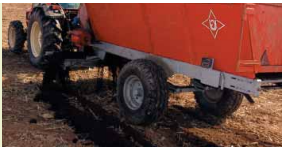
Esparcidor de estiércol con descarga lateral, adecuada para localizar el estiércol en una línea de plantación. Foto CMA.
