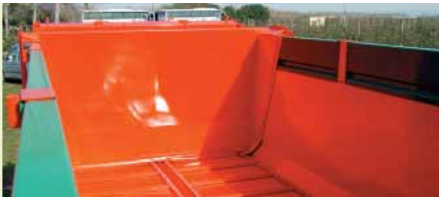
Las máquinas distribuidoras de deyecciones ganaderas están fabricadas con material resistente y protegido contra la capacidad corrosiva del estiércol. Foto: CMA.
