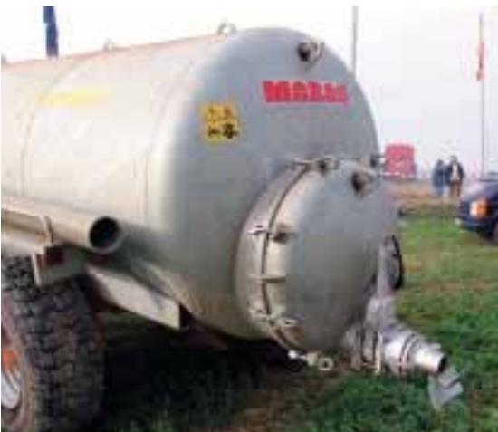
Cisterna de purín con sistema de distribución en toda la superficie mediante un cono-plato. Foto: CMA.
