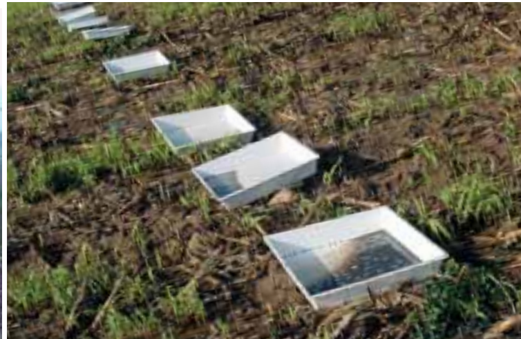
Determinación de la uniformidad de distribución transversal de un esparcidor de estiércol mediante cajas, de acuerdo con Norma UNE-EN 13080:2003. Foto: CMA
