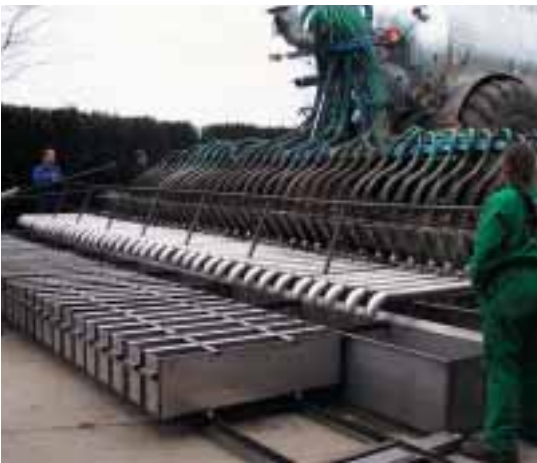
Determinación del caudal de cada una de las salidas de una cisterna de purines. Foto AAMS Iberica.
