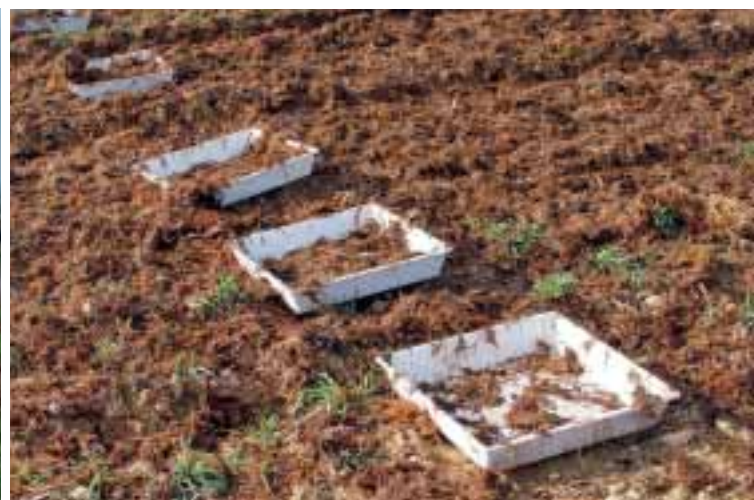
Determinación de la uniformidad de distribución transversal de un esparcidor de estiércol mediante cajas, de acuerdo con Norma UNE-EN 13080:2003. Foto: CMA
