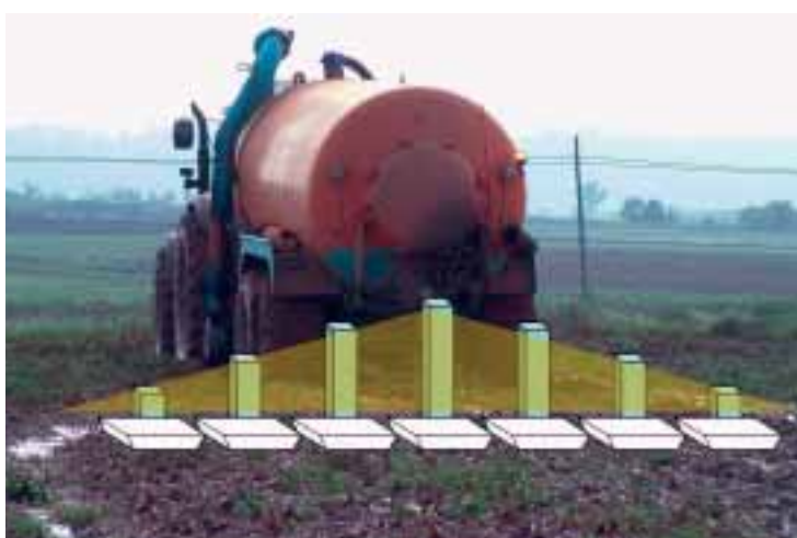
Diagrama triangular de recogida de líquido de las cajas de una cisterna con cono y plato. Foto: CMA.
