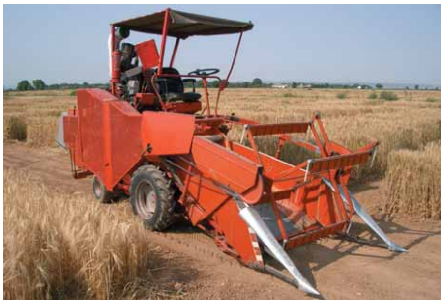
Microrecol·lectora d'assaigs Hege 125C. Foto: A. López Q.
