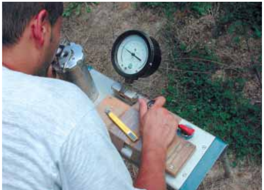
Fotografía 2. Medida del estado hídrico del árbol (potencial hídrico de tallo al mediodía solar) con una cámara de presión. El procedimiento realizado para medir el potencial hídrico del árbol es el siguiente: en primer lugar, se selecciona una hoja del árbol y se pone en una cubierta plástica recubierta de aluminio durante una hora. Una vez que el potencial de hoja se equilibra con el del tallo, se corta el peciolo en el punto de inserción en el tronco. La hoja se introduce en la cámara de presión y se le aplica presión con nitrógeno gaseoso hasta que la presión aplicada a la hoja iguala la tensión negativa con la que el agua está retenida en el interior de la hoja antes del corte. El valor obtenido es el potencial hídrico del tallo.
