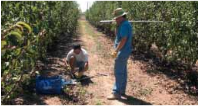
Fotografía 1. Medición de contenido de agua gravimétrico en respuesta a los tratamientos de riego y aclareo de fruta mediante barrenas a diferentes profundidades. Foto: IRTA Tecnología del Riego
