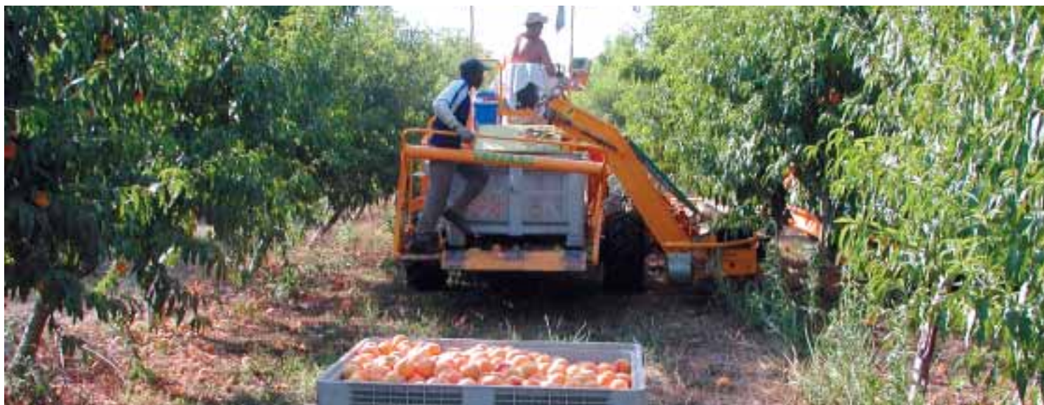
Foto 1. Màquina per a recol·lecció mecanitzada del préssec. Foto: IRTA Tecnologia del Reg.
