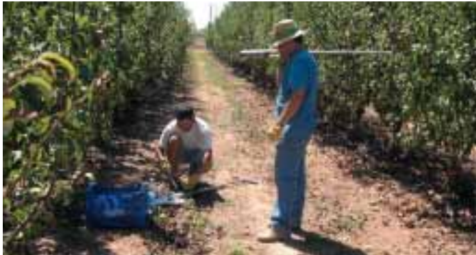
Foto 1. Mesurament de contingut d'aigua gravimètric en resposta als tractaments de reg i aclarida de fruita mitjançant barrenades a diferents profunditats. Foto: IRTA Tecnologia del Reg
