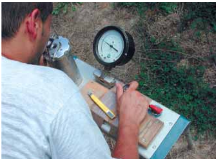
Foto 2. Mesura de l'estat hídric de l'arbre (potencial hídric de tija al migdia solar) amb una cambra de pressió. El procediment portat a terme per a amidar el potencial hídric de l'arbre és el següent: en primer lloc, se selecciona una fulla de l'arbre i es posa en una coberta plàstica recoberta d'alumini durant una hora. Una vegada que el potencial de fulla s'equilibra amb el de la tija, es talla el peciol al punt d'inserció al tronc. La fulla s'introdueix en la cambra de pressió i se li aplica pressió amb nitrogen gasós fins que la pressió aplicada a la fulla iguala la tensió negativa amb la qual l'aigua està retinguda en l'interior de la fulla abans del tall. El valor obtingut és el potencial hídric de la tija.
