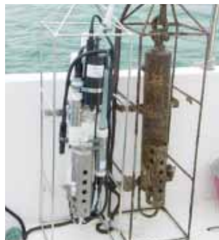
Foto 2: Sondes CTD (esquerra, abans d'immersionar-se; dreta, després d'un temps en el medi) utilitzades per al seguiment dels paràmetres ambientals. Autor: IRTA
