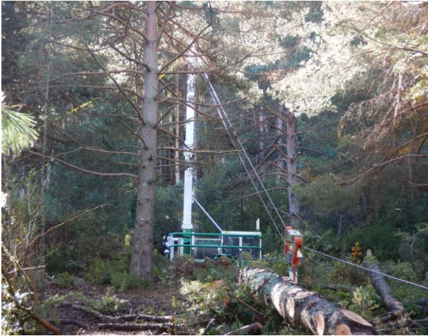
Foto 1. Desembosc amb cable aeri, marca Greifenberg model SIBERIAN, a Pont de Suert (Foto: AFIB-CTFC).
