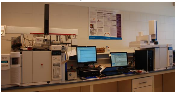
Foto 2 Foto 2. GC-MS utilizado para la determinación de aromas de los vinos.
