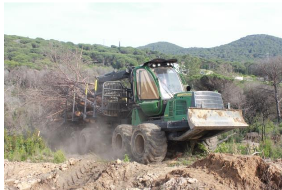
Figura 1. Desembosc de la fusta a les parcel·les experimentals. Imatge superior: Tractor forestal lleuger amb remolc autocarregador, carregant tronc a una parcel·la de tala sostenible (SL). Al fons s'observen els pins pinyers de la parcel·la de no intervenció (NI). Imatge inferior: Autocarregador d'elevat tonatge transportant arbres sencers a una parcel·la de tala convencional (CL). (Fotos: Pere Pons).
