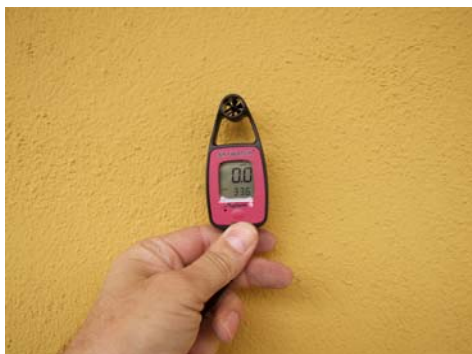
Figura 2. Detall d'un anemòmetre.(Foto: ECA Tàrrega).
